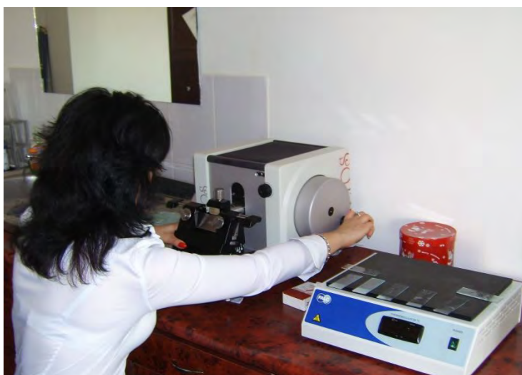
Microtom și plită histologică destinate realizării de preparate anatomopatologice - sală microscopie
